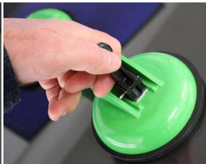
basculer les leviers pour verrouiller la ventouse
