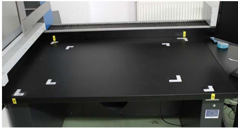
Le plateau pour le format A0 en position sur le scanner
