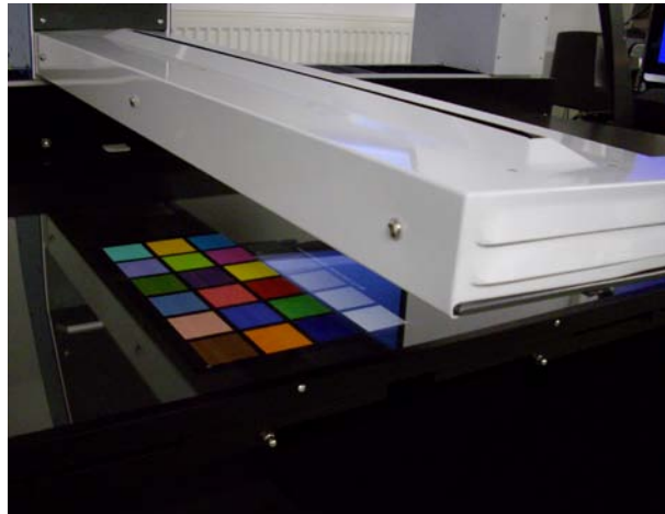
Placement de la mire sur le scanner
