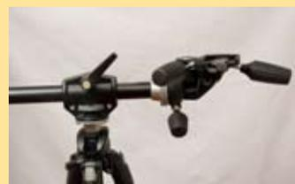
(2) clipser le sabot de l'appareil photo sur la rotule 3D (blocage automatique)
