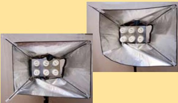
(6) repositionner et retendre la toile réfléchissante en re-scrachant les coins gauche inf et sup sur eux-mêmes.
