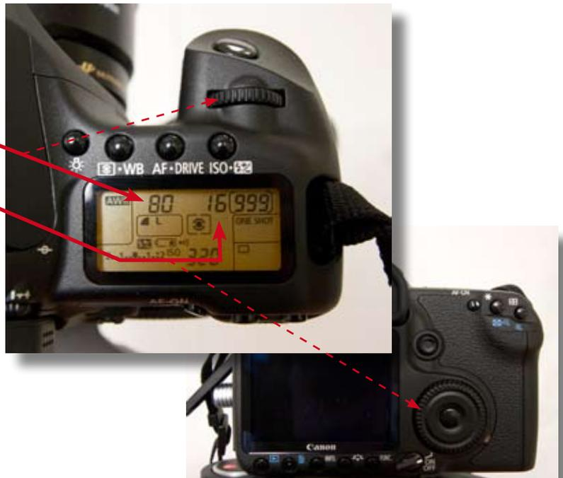
Vérifier que les commutateurs de l'objectif soient positionnés sur «AF» et sur «ON» (STABILISATEUR)
